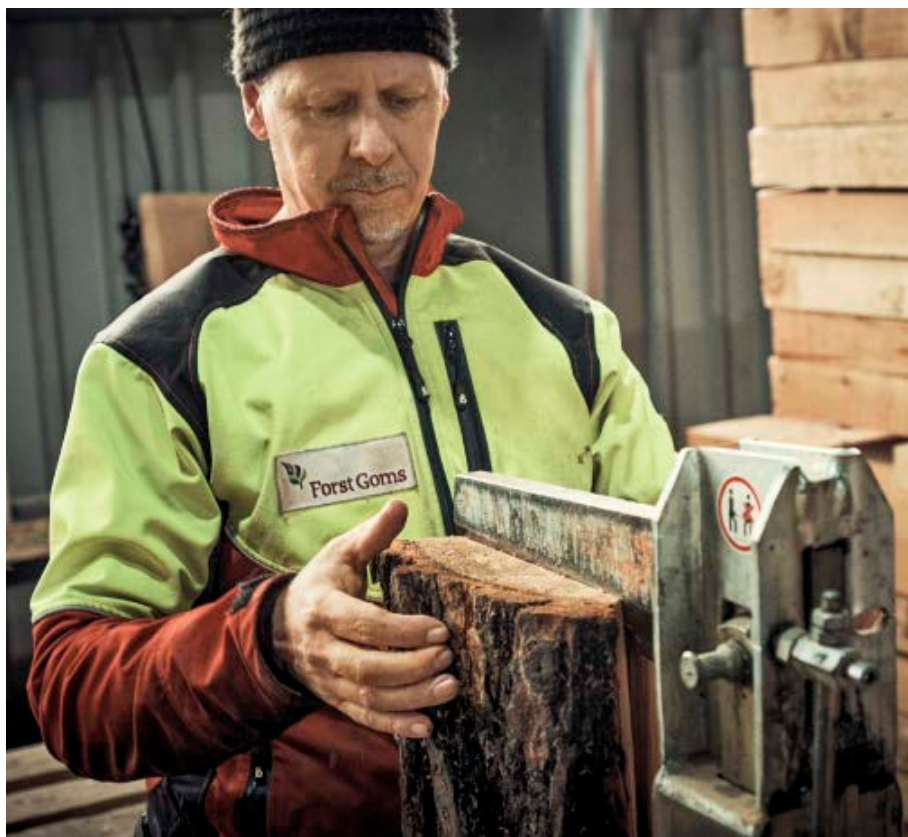
Stück für Stück werden die Schindeln – hier mit der Maschine – vom Lärchenholzblock abgetrennt.
